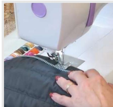
**03.** Passe uma costura à máquina sobre o zíper, utilizando o pé calcador de rolete.
