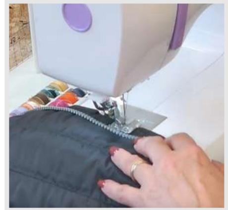
**03.** Passe uma costura à máquina sobre o zíper, utilizando o pé calcador de rolete.
